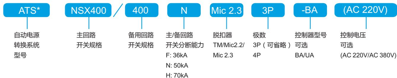
ATS自动电源转换系统提供标准配置型号和定制型号。
