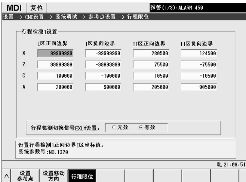
该页面显示了行程检测 1 的两个检测区域的边界坐标值, 并允许用户设置 EXLM 信号有效, 来切换两个检测区域。
