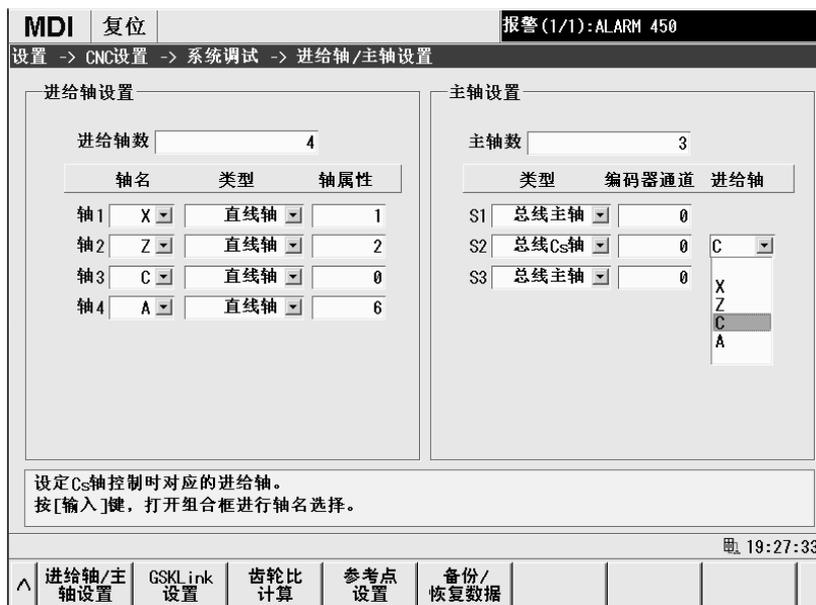
注：设置了 Cs 轴的轴名后（如本例中的 C 轴），C 轴的类型自动被设置为 A 型旋转轴，同时轴属性也设置为 0。
