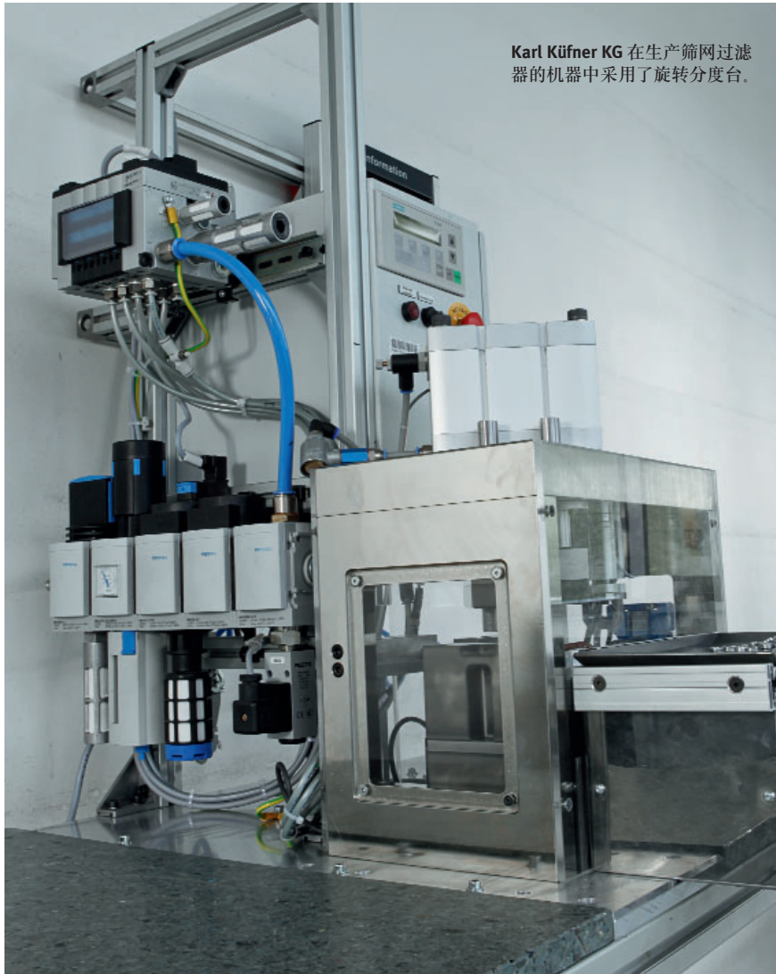
成功的伙伴关系：角圈和织物材料组合后，标准气缸推走旋转分度台 DHTG 上的工件，将工件送入弹出设备。
