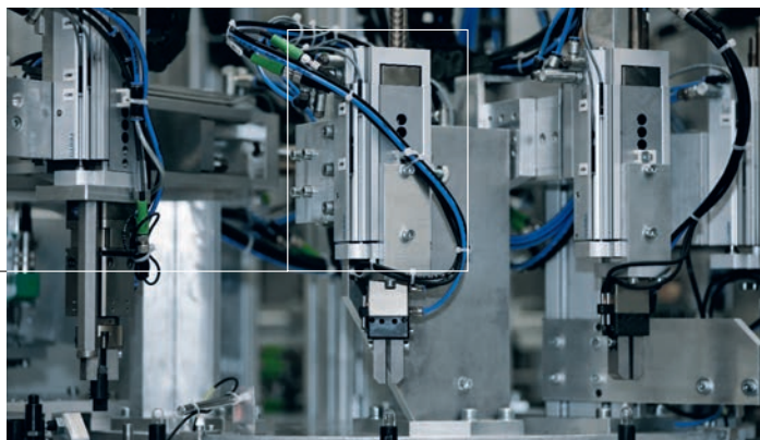
▼ 小型滑台式气缸 DGSL 实现了机器上抓放搬运的垂直运动。
