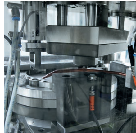
成功的伙伴关系：角圈和织物材料组合后，标准气缸推走旋转分度台 DHTG 上的工件，将工件送入弹出设备。
