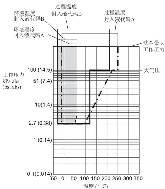
图 1-1. 工作压力和过程温度
