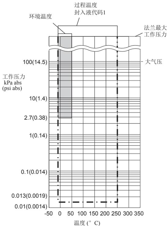
图 1-3. 工作压力和过程温度
