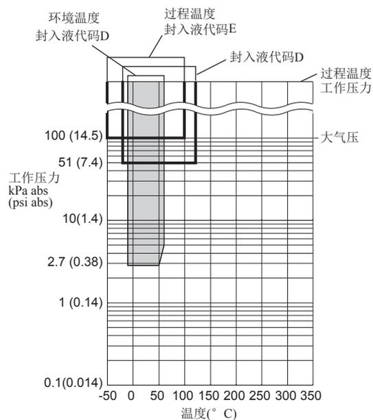
图 1-2. 工作压力和过程温度
